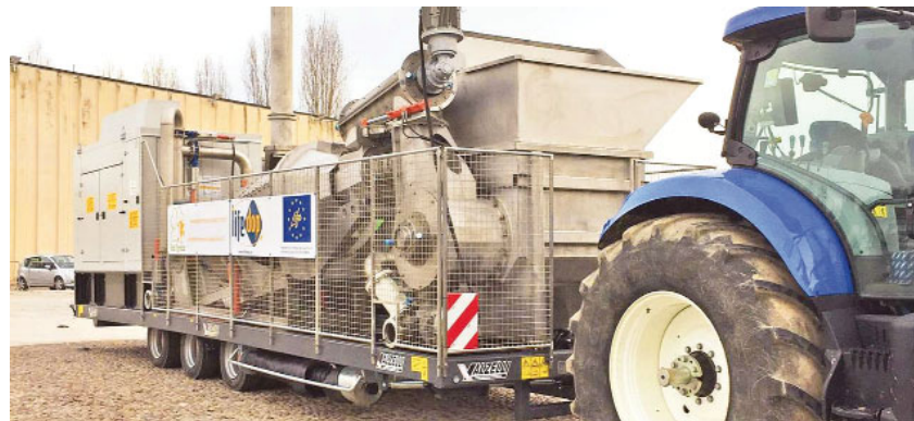
Il separatore mobile presentato a Gonzaga. La macchina viene utilizzata nelle aziende zootecniche per dividere il materiale secco dai liquami. Attualmente sono quattordici gli allevamenti che la usano
